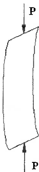
figura 7 – placa com uma carga aplicada no plano
